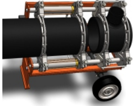
Düz ve inegal te borularının bağlantı şekli Installation of straight pipe and reducing tee Сварка трубы с редуционным тройником
