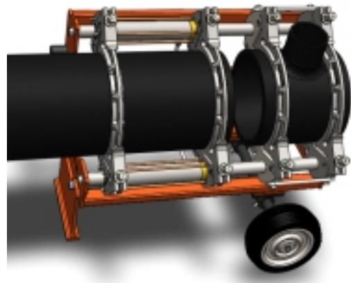
Düz ve inegal te borularının bağlantı şekli
