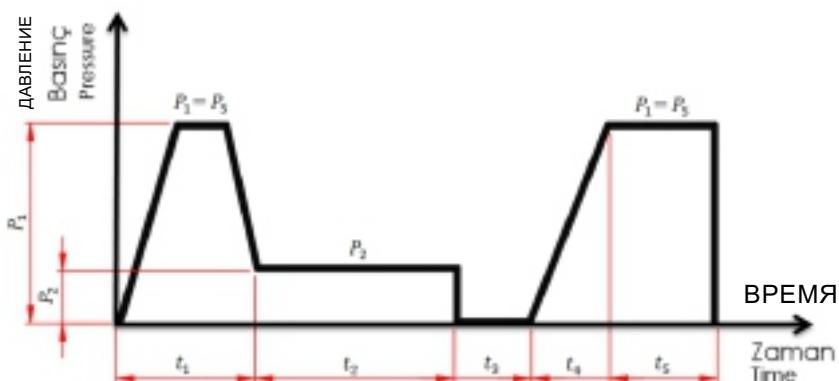
$t_1$ : İstenilen dudak kalınlığı için gereken süre
