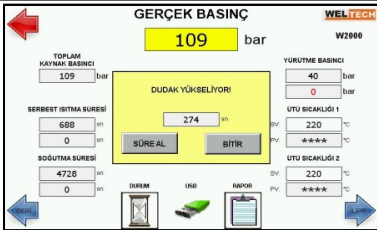
16- CNC W630 K SERİ Alın kaynak makinesi dudak yüksekliği standart değere geldiği zaman basınçsız ısıtma işlemine otomatik olarak geçer. İstenen dudak yüksekliği sağlanmamışsa ekrandaki uyarı çıkar buna göre basınçlı ısıtma süresi devam eder. Dudak yüksekliği standart değere
