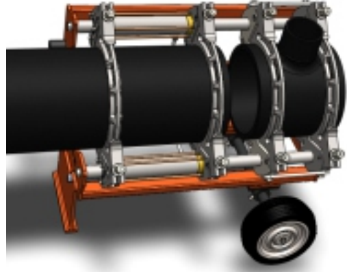
Düz ve inegal te borularının bağlantı şekli Installation of straight pipe and reducing tee Сварка трубы с редуционным тройником
